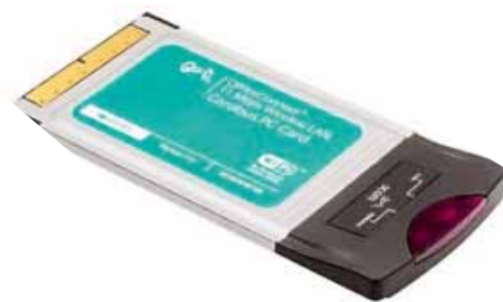
Die W-LAN Karte als Sende- und Empfangseinheit im mobilen Endgerät
